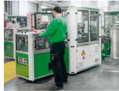
Fertigungszelle der Dämpfermontage.
